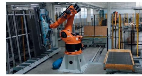
La carga vertical de las placas aumenta la capacidad de almacenamiento y reduce la posibilidad de rotura.
